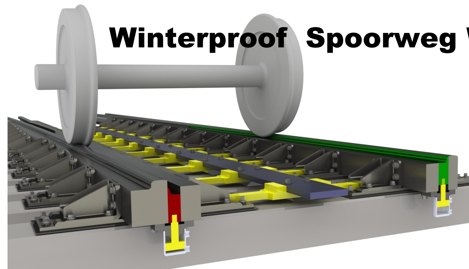
Linker en rechter wisseltong worden verticaal bewogen door 5 kleine hydraulische actuators per wisseltong.
